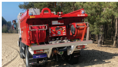
Opklapbare achterbumper t.b.v. offroad inzet
