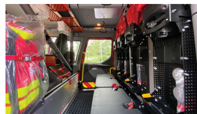
Manschappencabine voorzien 4 zitplaatsen met geïntegreerde ademluchthouders in de rijrichting
